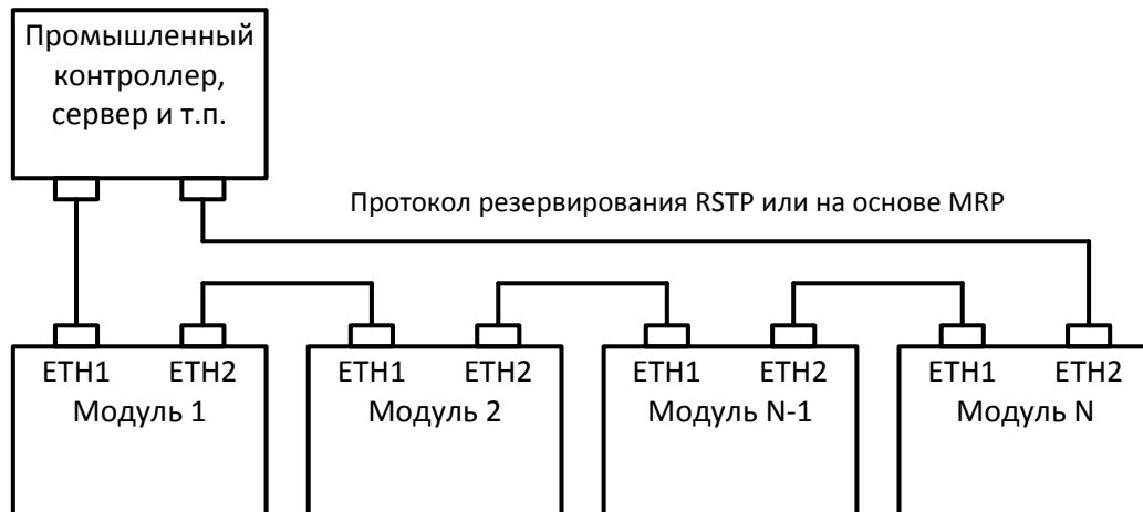
Рисунок 5.8– Кольцевая схема подключения к сети Ethernet
